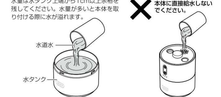
水量は水タンク上端から1cm以上余裕を残してください。水量が多いと本体を取り付ける際に水が溢れます。
