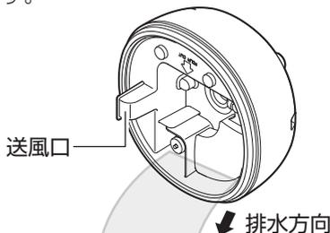
本体の送風口に水が入らないように、必ず、右図の方向から排水してください。
