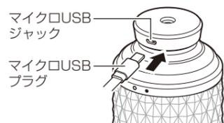
② 専用USBケーブルのUSBプラグをパソコン、ACアダプターなどのUSBポートに接続してください。
