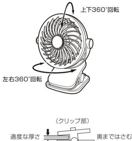
**△注意** クリップにはUSBケーブルなどはさみ込まないようにしてください。故障や火災の原因となります。クリップでの取り付けは、十分強度がある場所を選んで行ってください。重さだけでなく、クリップのはさむ力にも耐えられる、丈夫なところへ取り付けてください。クリップは奥まで差し込んでください。クリップの差し込みが浅いと落下してしまう可能性があり、大変危険です。
