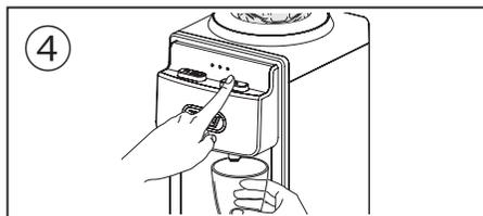
出水口から水が出てくるまでボタンを下げ続けてください。たまっている空気が抜け、水が出るとエアー抜き完了です。また、本体内部に水が入っていかず空気の泡がポコポコと出ない場合は、セットした飲料水ボトルを何度かセットし直し、水が送り込まれるのを確認してください。※エアー抜きが完了しないと水が出てきません。
