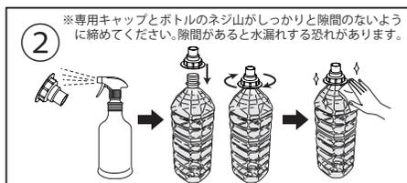
使用する飲料水ボトルに合う2Lボトル用専用キャップ(φ25mm、φ28mm)を選び、しっかりと締めてください。飲料水ボトルの表面にほこりなどが付着している場合は、きれいに拭き取ってください。
