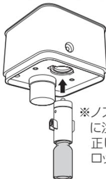
※ノズルユニットの向きに注意してください。正しい向きでのみ、スロットに押込めます。
